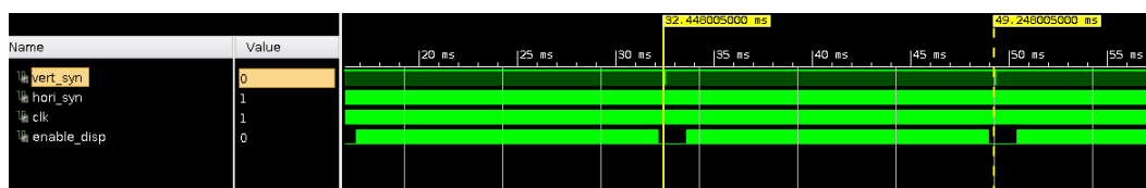
Obrázek 5.20: Simulace a kontrola pulzů VSYNC (Zdroj: Vlastní zpracování)
